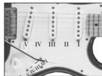
Les micros de la Stratocaster et le sélecteur. Les positions indiquées dans l'ouvrage se réfèrent à ce schéma.
